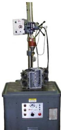
**Broken Bolt / Stud Removal**
